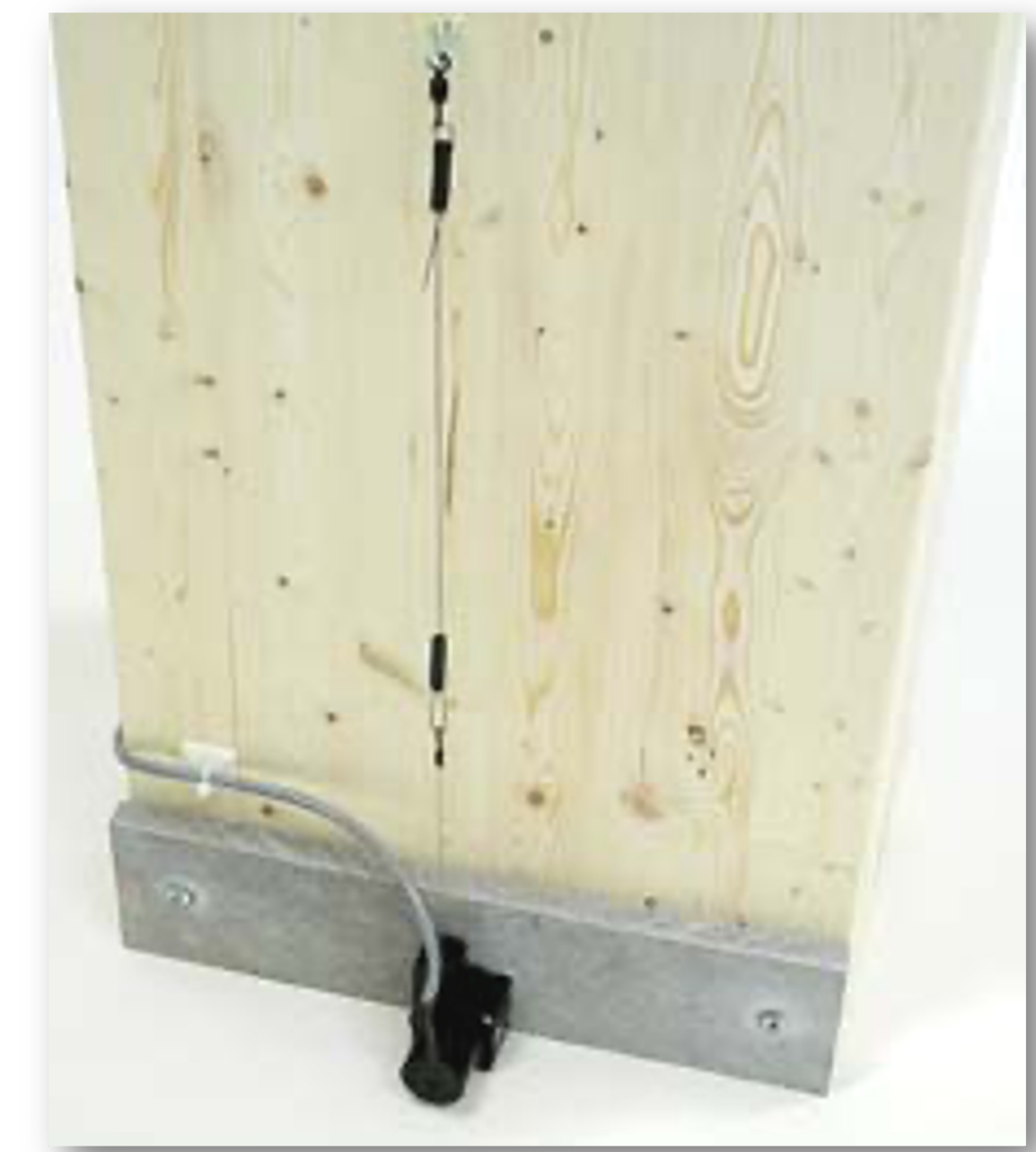
Installation d'un potentiomètre pour mesurer le déplacement total
